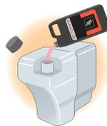
假如您添加或更換含有高比例水分的非正廠冷卻液或只是一般的水，這樣就無法適當地冷卻引擎，而且也不能防止生鏽或凍結情形。另外，非正廠冷卻液不僅無法提供與正廠 Toyota SLLC 一樣的功能，更換週期也較短。
